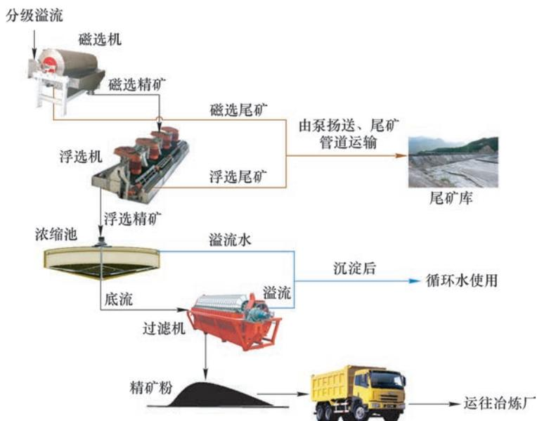
■ 铁矿选厂一般生产工艺流程
