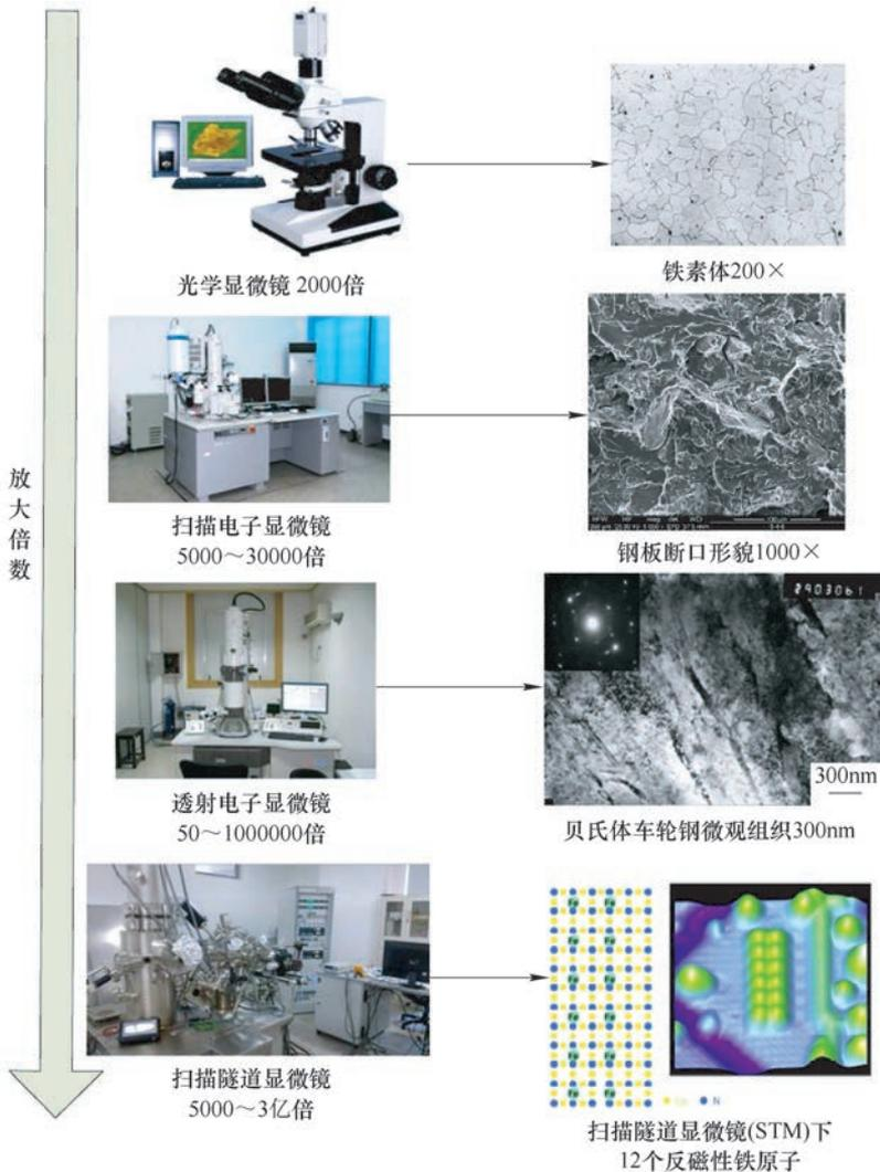
■ 不同级别显微镜下钢铁组织结构
