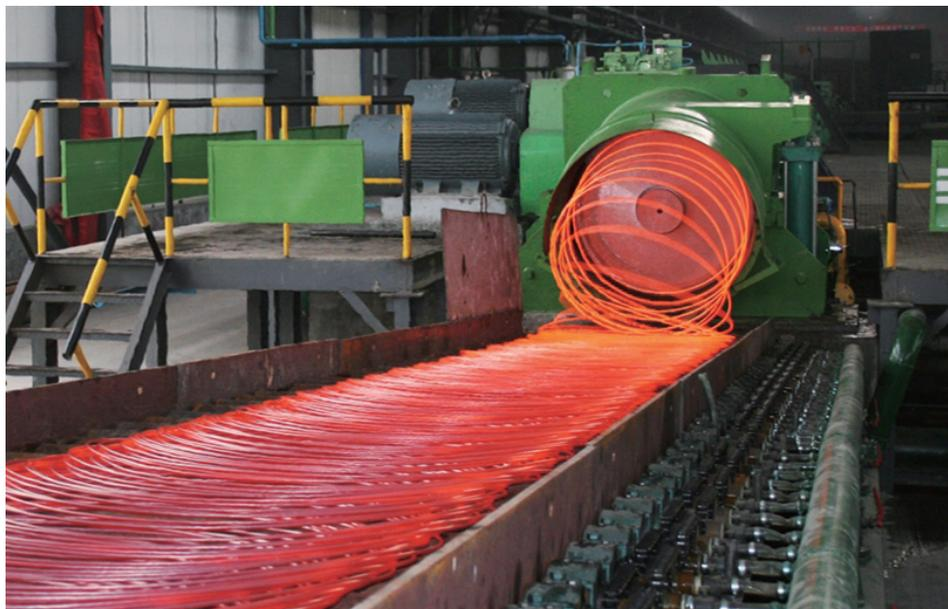
■ 高速线材轧制生产线
