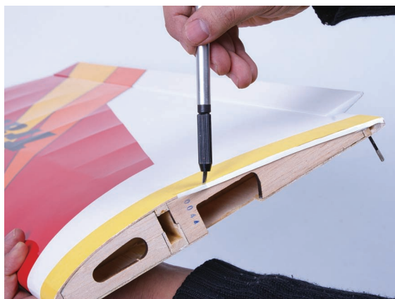
图 3-23 用刀片切除多余热缩膜及美纹胶
