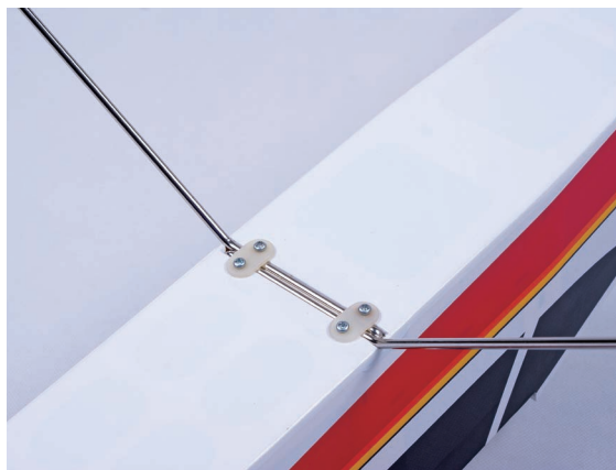
图 3-61 用压片紧固起落架钢丝
