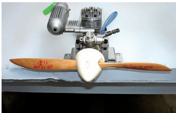
图 4-18 螺旋桨安装角度要正确
