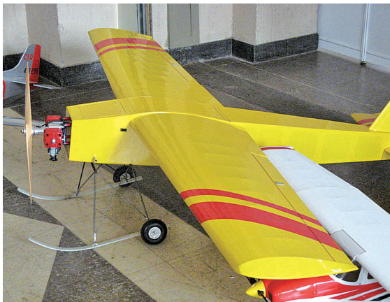
图 2-57 滑橇式起落架
