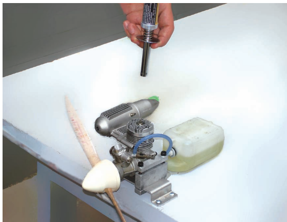
图 4-26 发动机启动后取下点火器
