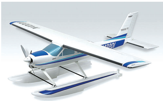
图 2-56 浮筒式起落架
