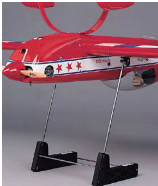
图 6-38 倒放姿态下测量重心
