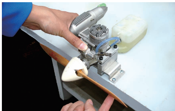
图 4-23 检查发动机吸油
