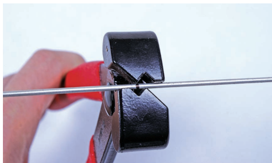
图6-16 Z形钳直角刀口对准记号
