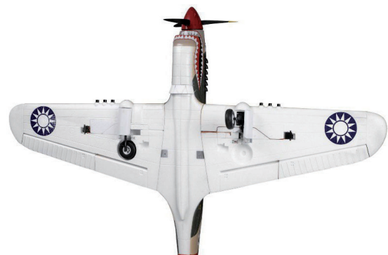
图 2-55 收放式起落架（飞行时收到机翼内）
