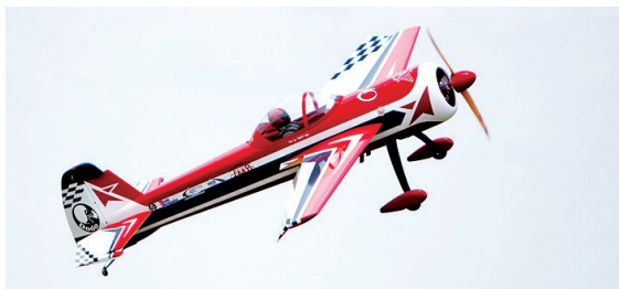
图 2-52 后三点式起落架
