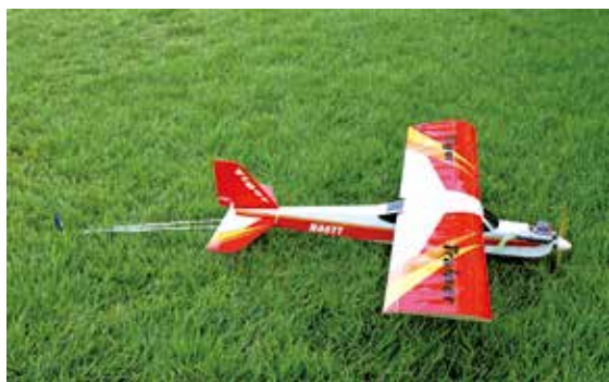
图 4-16 磨合时用绳子挂住机尾
