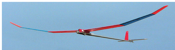
图 2-11 F1C 发动机动力模型滑翔机
