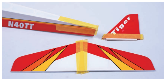
图 3-39 在尾翼和机身贴美纹胶带
