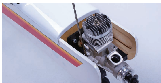
图 3-52 发动机螺栓孔定位
