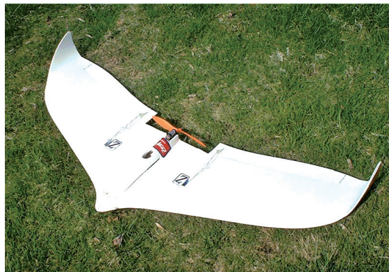
图 2-65 采用“S”翼型的模型
