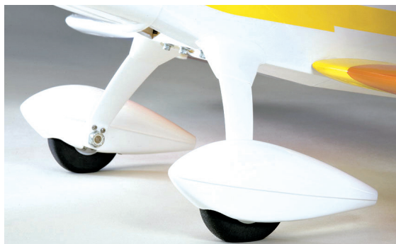
图 2-53 固定式起落架
