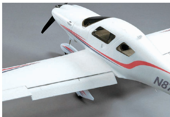
图 2-60 襟翼设在翼根处
