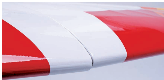
图 3-20 机翼前缘扭曲
