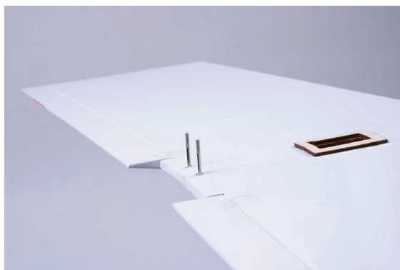
图 3-33 摇臂钢丝平行安装
