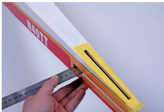
图 3-41 测量槽口前缘宽度
