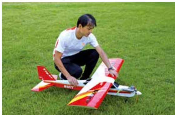
图 4-15 磨合时要扶牢模型飞机
