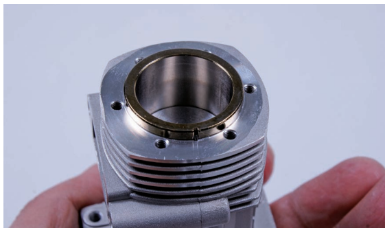
图 4-11 汽缸衬套边缘定位销
