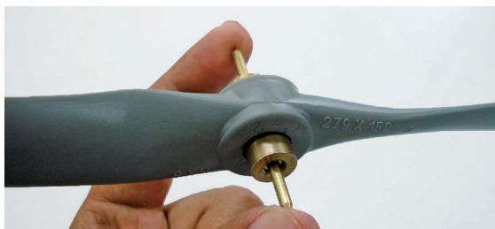
图 4-41 检测螺旋桨左右桨叶重量
