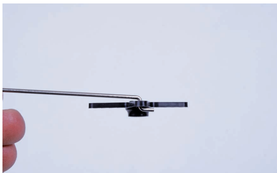
图 3-78 操纵钢丝采用“Z”形弯
