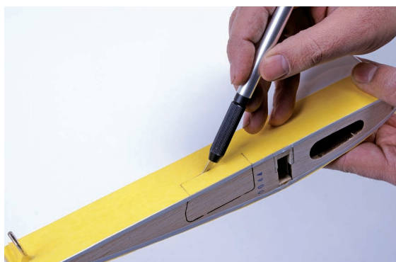
图 3-24 切开副翼舵机位置预留孔
