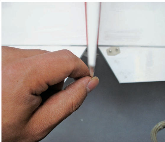
图 3-95 舵面间隙的检查
