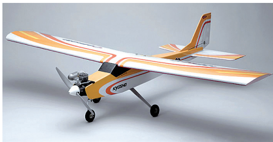
图 2-51 前三点式起落架
