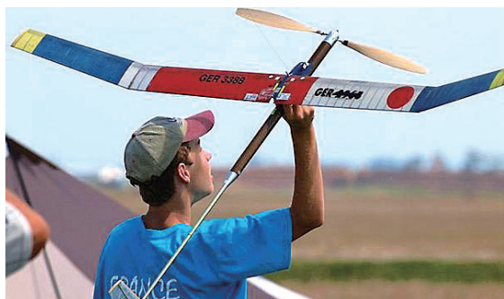
图 2-9 橡筋带动螺旋桨
