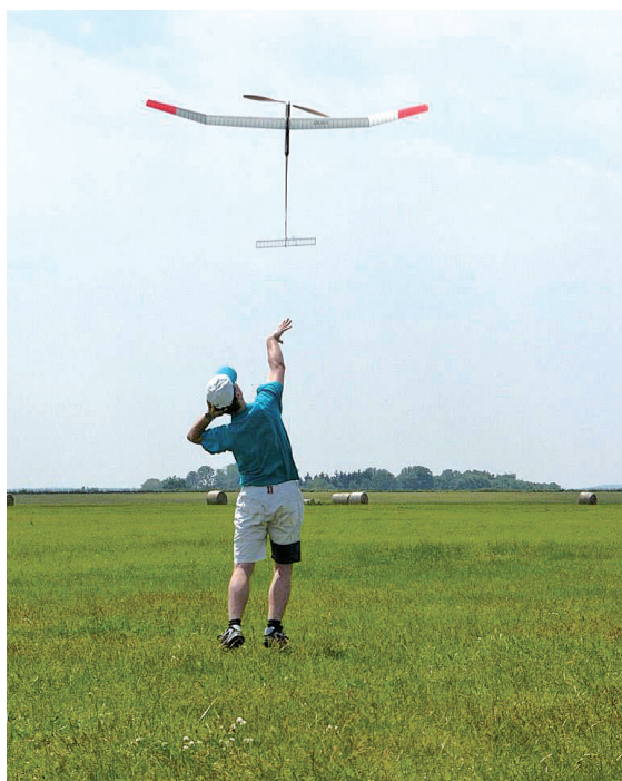
图 2-8 采用螺旋桨起飞（橡筋带动螺旋桨）
