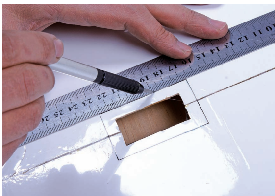
图 3-29 用刀片切去热缩膜
