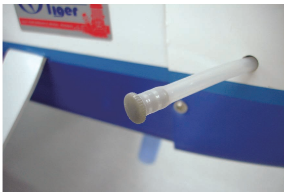
图 3-57 用塞子堵好加油管
