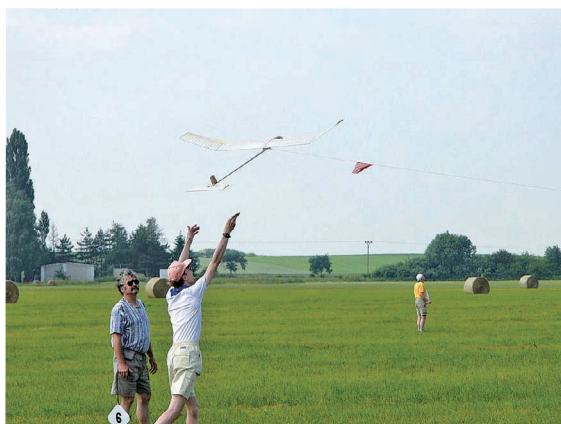
图 2-6 牵引线牵引模型飞机起飞
