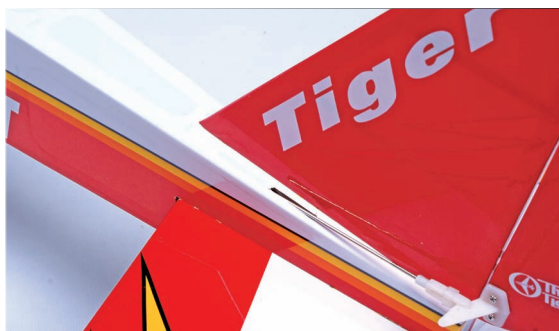
图 3-69 将钢丝引出机身并与舵面摇臂连接
