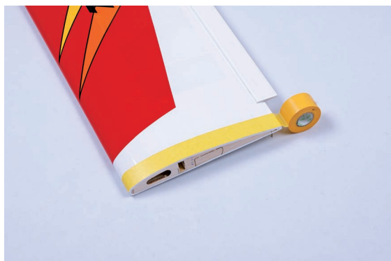
图 3-22 翼根边缘粘美纹胶带
