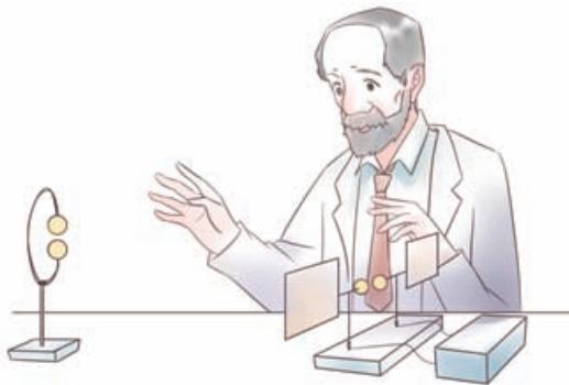
赫兹发现电磁波的实验装置。
