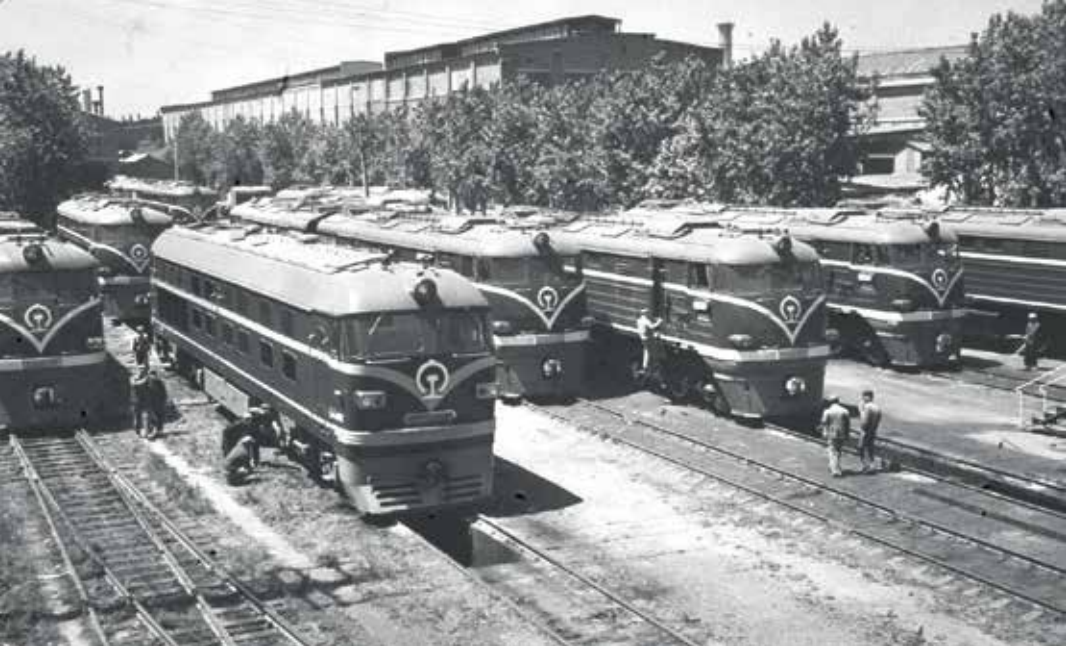
▲ 1980年，辽宁大连机车厂生产的四千马力东风四型内燃机车。这是中国当时生产的内燃机车中质量最好的一种。（刘东民摄）
