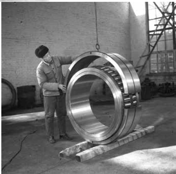
▶ 1980年3月，我国第一套特大型的部分式双列球面滚子轴承，在辽宁省瓦房店轴承厂制造成功。由这个厂自行设计和制造的这种轴承，用在150吨氧气顶吹转炉耳轴上，更换简便，调整方便，可缩短维修周期。它的制造成功，填补了我国轴承工业的一项空白。
