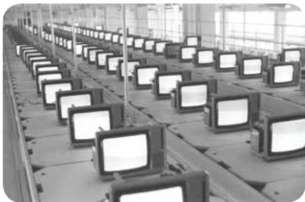
▲ 1980年10月，我国第一条彩色电视机生产线在国营天津无线电厂建成并投入试生产。它的设计能力为年产14英寸和22英寸彩色电视机15万台。这条生产线是从日本胜利公司引进并参照我国实际情况设计的，自动化程度高，外形美观，噪音小。图为试生产装配的彩色电视机在通过老化检验。（新华社记者李昌元摄）
