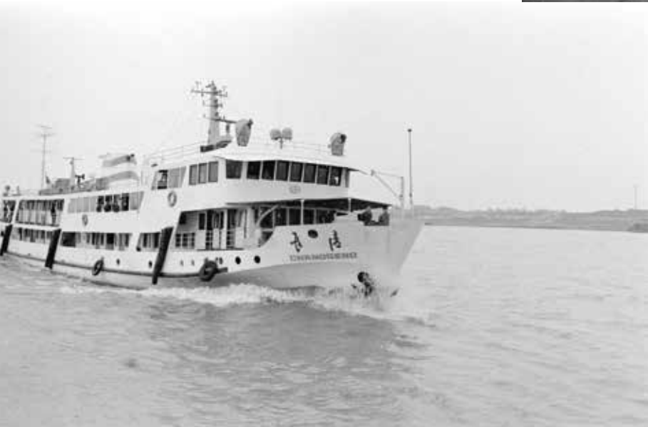
◀ 1980年，我国自己制造的第一艘水质监测船——“长清”号在长江进行水质监测。这艘船长50米，宽8.6米，排水量为500吨，有40名工作人员。船上设有自动化、化学、水生生物、色谱分析、微生物、原子吸收分光光度、放射性、水文气象等9个监测实验室，监测项目有40多个，所有设备都是国产的。（新华社记者张申明摄）
