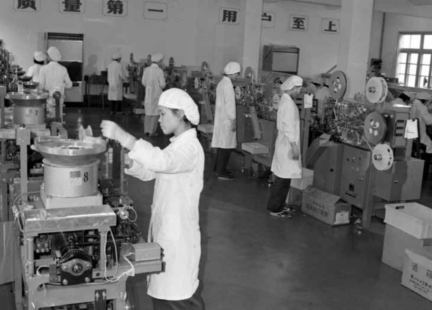
▲ 至1984年，厦门特区已与80多个国家和地区建立了贸易关系。图为厦门鼓浪屿无线电器材厂从日本引进铝电解电容器自动生产线，生产的产品质量优良，供国内100多家工厂使用。（新华社记者黄兴泉摄）
