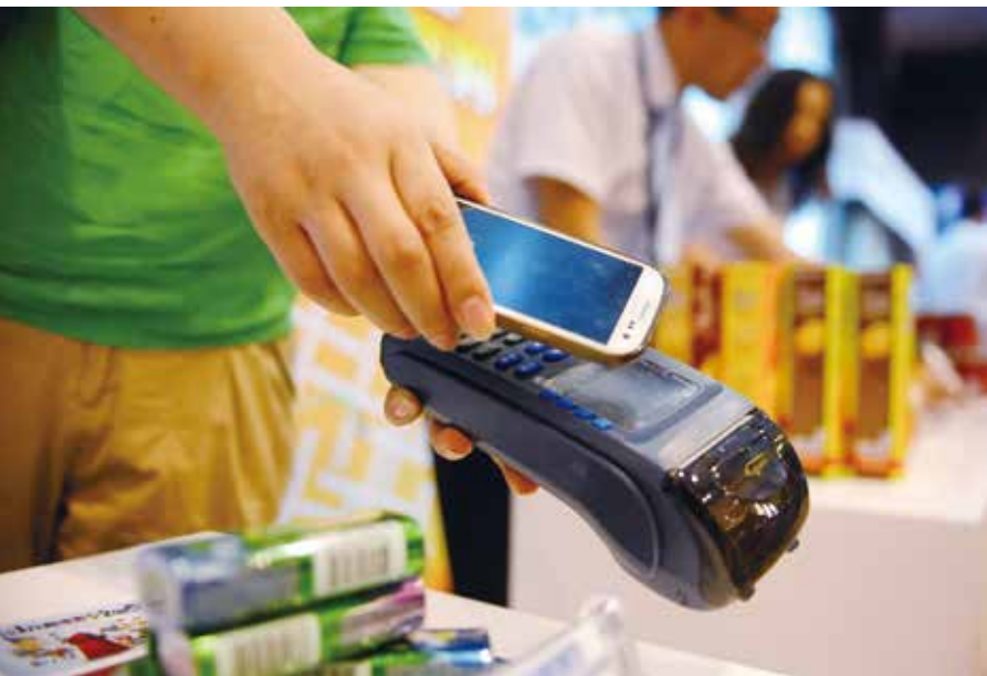
◀ 2013年8月20日，工作人员演示用NFC手机支付功能进行刷卡消费。当日，中国移动甘肃公司与浦发银行兰州分行共同推出甘肃省首张手机支付银行卡。这款NFC手机支付产品是我国正式上市的具有自主知识产权、基于SIM卡的手机支付银行卡。NFC手机支付就是将银行卡信息写入手机SIM卡，并直接通过手机完成包括卡片开卡、账户充值、支付在内的诸多金融服务交易，无需任何银行网点或自助设备，可在全国各类消费场所120余万台标有银联“QuickPass 闪付”标示的POS机上使用。（新华社记者张钰摄）
