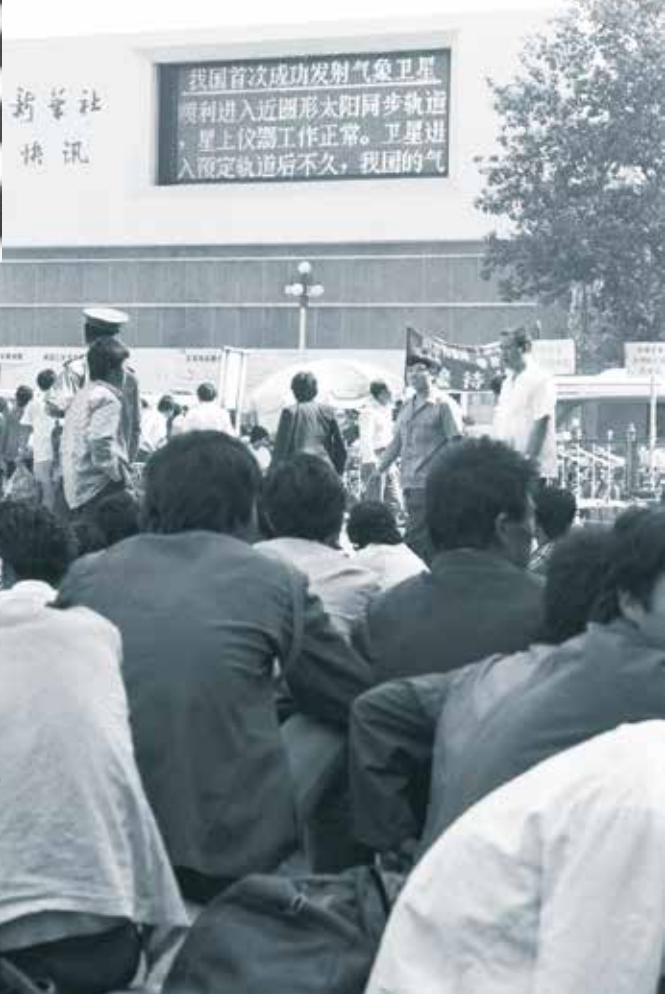
▼ 1988年9月，耸立在北京火车站广场东侧的新华社快讯大屏幕。其显示面积为41.6平方米，每天播放新闻12小时。新华通讯社在北京火车站设置的我国第一套大屏幕高亮度新闻快讯发布系统，于1988年9月12日正式使用。大屏幕显示屏由16640只绿色象元管组成点阵，可显示文字和图像，层次丰富，有伴音，并能播放录像及转播电视节目。（新华社记者戴纪明摄）
