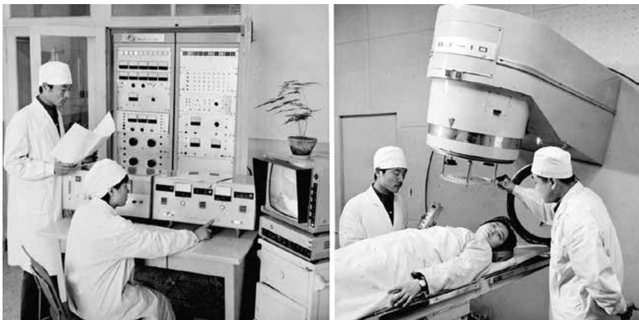
▲ 1979年7月，北京市肿瘤防治研究所的医务人员使用我国自制的第一台医用电子直线加速器对癌症病人进行治疗。这种医用电子直线加速器是现代医学治疗癌症的一种重要工具，它既适合治疗人体深部内脏的恶性肿瘤，也可治疗人体浅层的恶性肿瘤。具有疗效高、副作用小、照射时间短等一系列优点，每天可治疗80名左右病人。左图是医务人员在操作，右图是病人在接受治疗。（新华社记者喻惠如摄）
