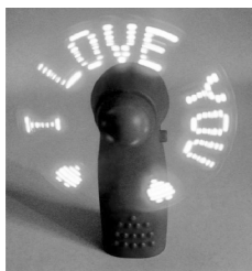
(b) 闪字风扇,扇叶转动时显示预先设定的内容
