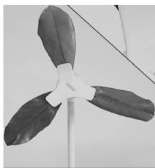
(a) 没有扇叶的风扇,该微型扇只有三个夹子,可夹持树叶等充当“扇叶”
