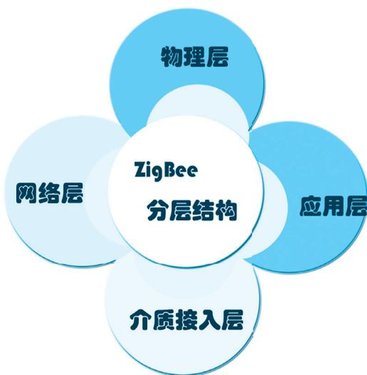
ZigBee 协议标准采用传统的 OSI（Open System Interconnect）的分层结构，主要分为物理层（PHY）、介质接入层（MAC）、网络层和应用层。其中，物理层和介质接入层由 IEEE 802.15.4 工作组制定，而网络层和应用层则由 ZigBee 联盟制定。
