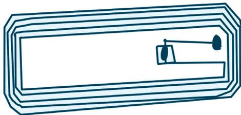
② 半主动式标签本身有电池，电池只对自身的数字电路供电，数据发送通过阅读器的能量场激活后，通过反射方式发送，感应距离较远。
