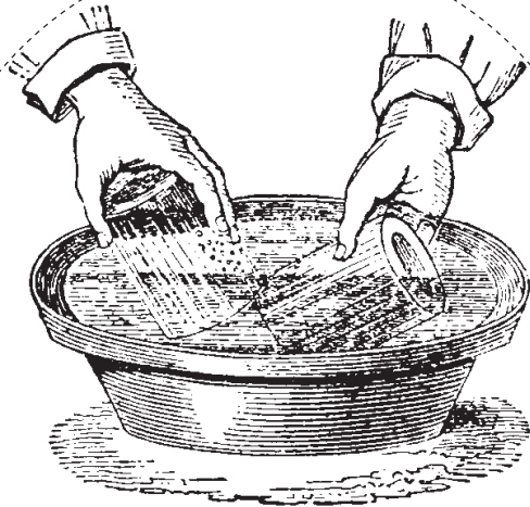
图3 转移气体的简易装置
