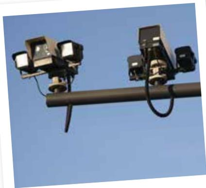
首先，“电子眼”是采用感应线圈来感应路面上的汽车传来的压力的，它通过传感器将这个压力转换得到的信号采集到中央处理器，再送往寄存器暂存，而这个数据在一个红灯周期内是有效的。其次，在同一个时间间隔内，也就是在一个红灯周
